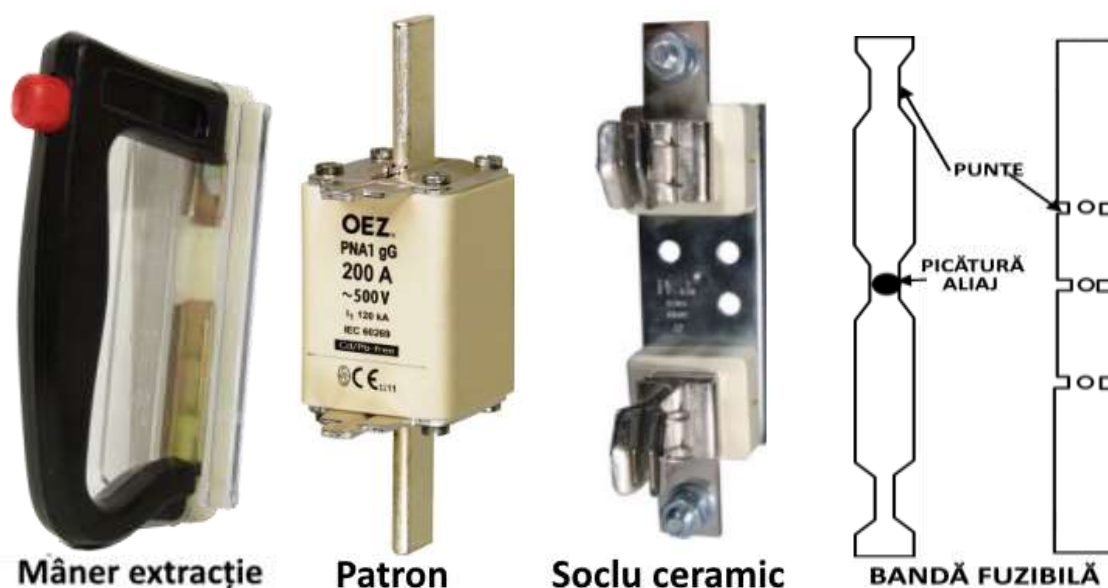
Figura 3.3 Elemente constructive siguranță fuzibilă cu mare putere de rupere
