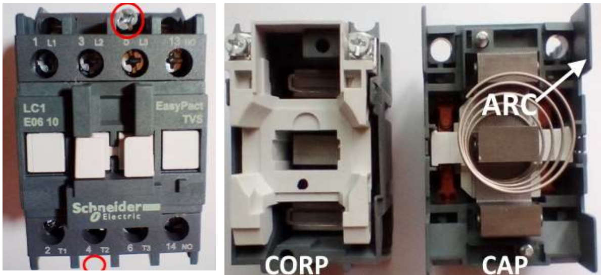
Figura 3.38 Demontare cap contactor.
